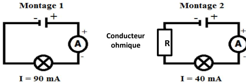
Lorsqu'on ajoute un conducteur ohmique (résistance) à un circuit électrique, la lampe ne brille bien et l'intensité de courant diminue.
